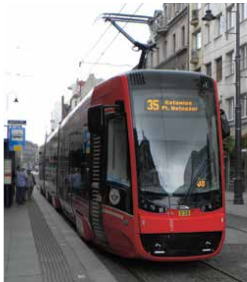
Tramwaj Pesa Twist 2012N na zmodernizowanym torowisku w ul. 3 Maja w Katowicach.
