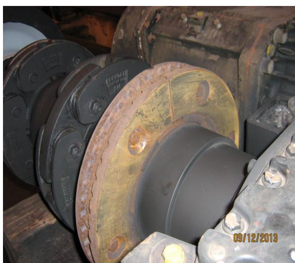
Zdjęcia tarczy wózka napędowego.
