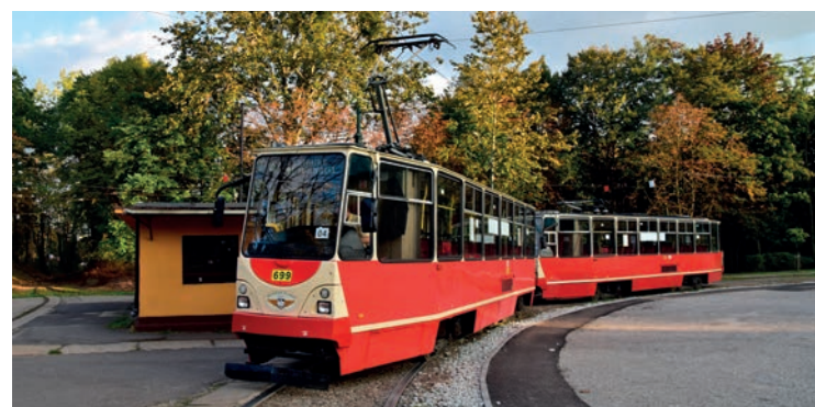
Skład wagonów typu 105 Na po remoncie kapitalnym
