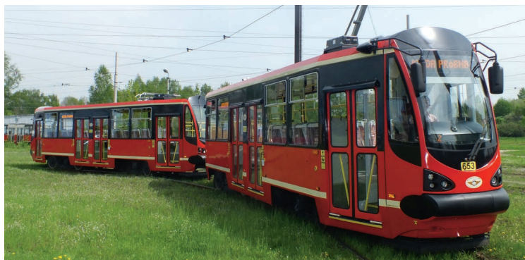
Skład pierwszych wagonów zmodernizowanych przez ZUR (105NF S) na terenie zakładu w Chorzowie
