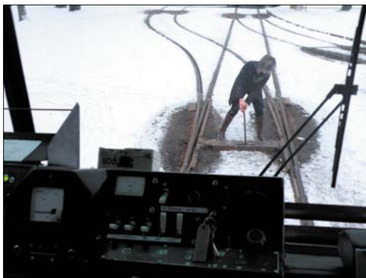
Maria zmienia zwrotnice. W zimę nie sprawia to już większych problemów, bo zwrotnice są podgrzewane.
