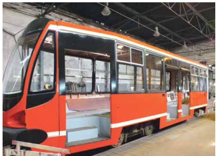
Modernizacja tramwaju typu 105 N w Zakładzie Usługowo Remontowym w Chorzowie.
