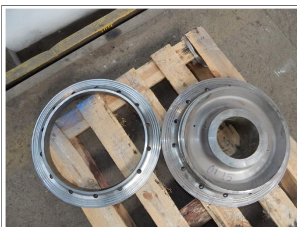
Piasta i pierścień dociskowy piasty koła wózka napędowego
